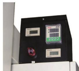
Состоит из 3 независимых стоек и электронного передатчика звукового сигнала с установкой и отображением количества крепежа, оставшегося для запрессовки.
