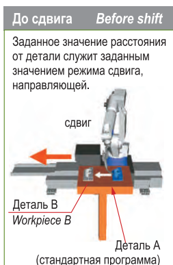
Величина сдвига задается путем ручного перемещения направляющей
