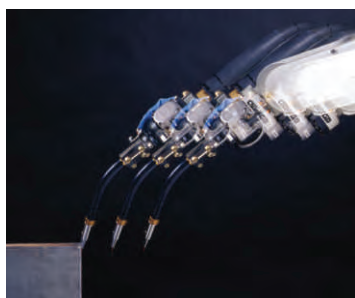
Датчик определения положения детали
