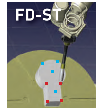
Маркировка возможна в конечных точках, на контурных линиях и во всех других точках гладкой поверхности.
