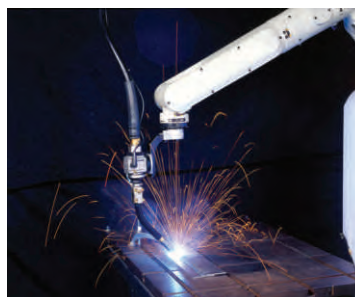
Датчик слежения за швом для MIG/MAG-сварки
